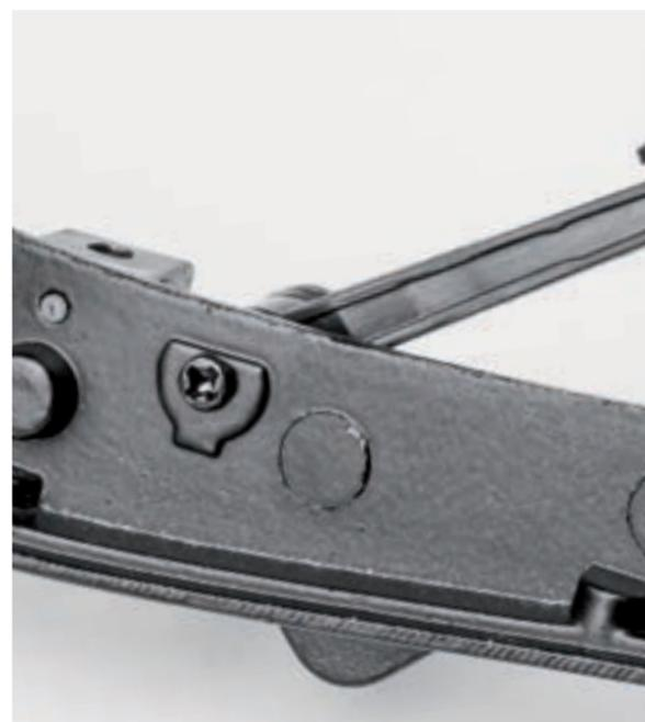
**Шаг 5.** Аналогичным образом с внутренней стороны лонжерона закрепите корпус главного тормозного цилиндра при помощи винта 2,3×5 (LP).
