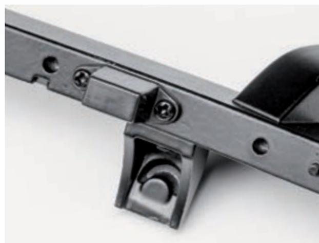
**Шаг 10.** Рядом с буфером на нижней плоскости лонжерона установите левый брызговик двигателя. Зафиксируйте деталь двумя винтами 2,3×5 (IM). Обратите внимание: плоскость брызговика должна быть изогнута вниз, в сторону от лонжерона рамы.
