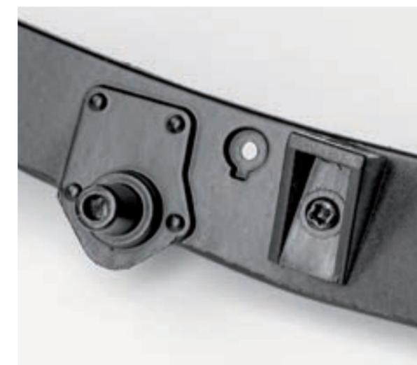
**Шаг 4.** Поместите собранный ранее педальный узел на внешнюю часть переднего левого лонжерона около кронштейна крепления кузова. Совместите центровочные метки оси штоков педалей и лонжерона и зафиксируйте деталь винтом 1,7×5 (JP) с внутренней стороны лонжерона.
