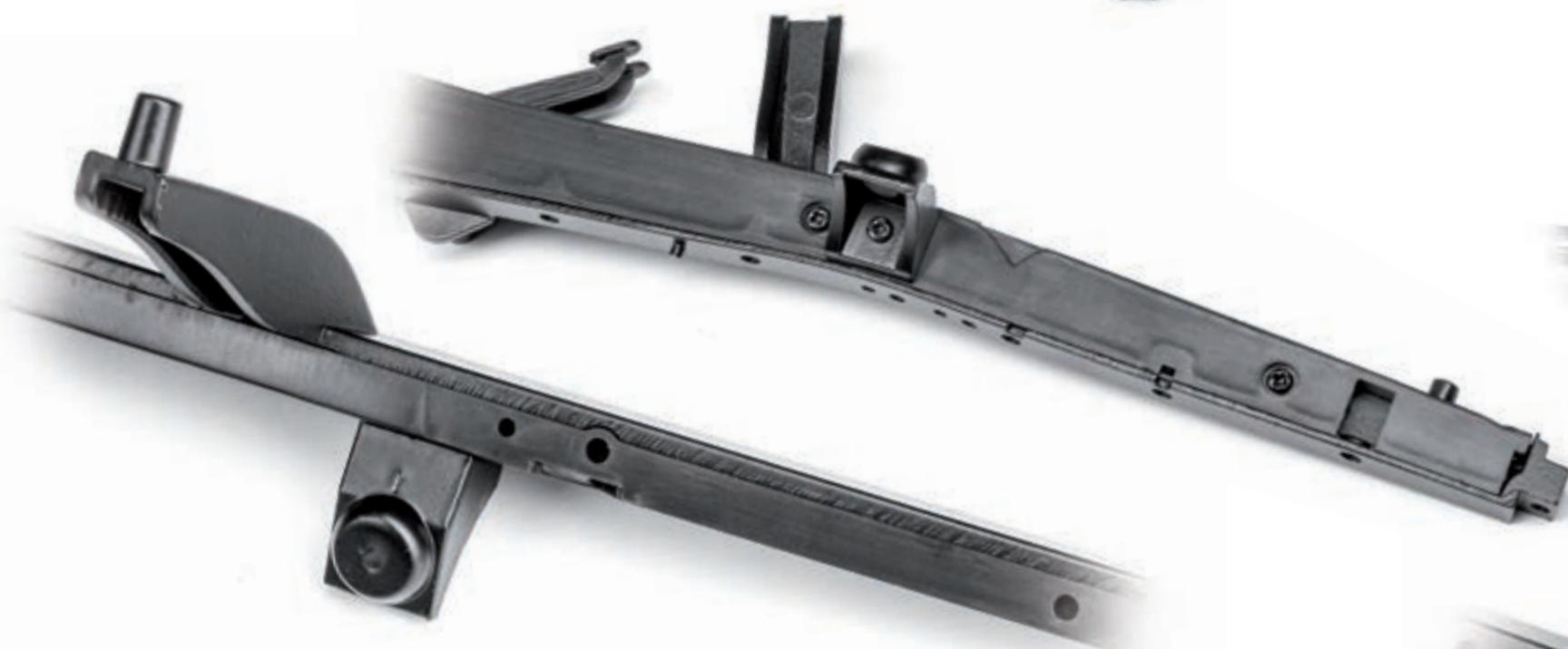
**Шаг 9.** На нижней плоскости передней половины левого лонжерона установите и закрепите двумя винтами 1,7×4 (СМ) буфер рессоры.
