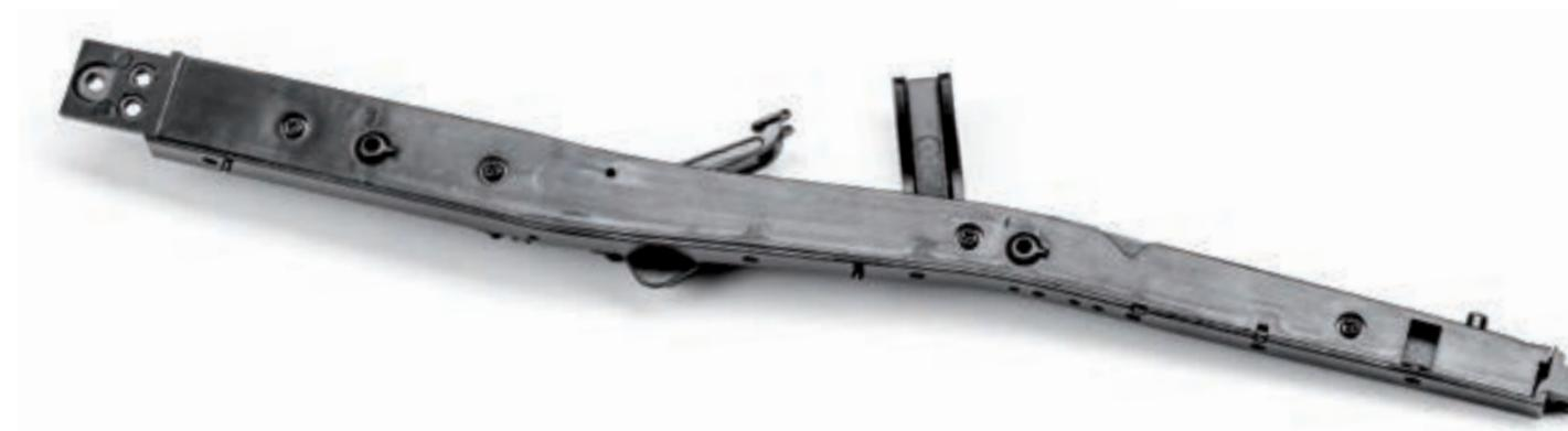
**Шаг 7.** В задней части левого лонжерона, с внутренней стороны, установите левый задний кронштейн крепления двигателя (деталь имеет маркировку «3»). Для этого совместите центровочные метки и закрепите деталь винтом 2,3×5 (IM).
