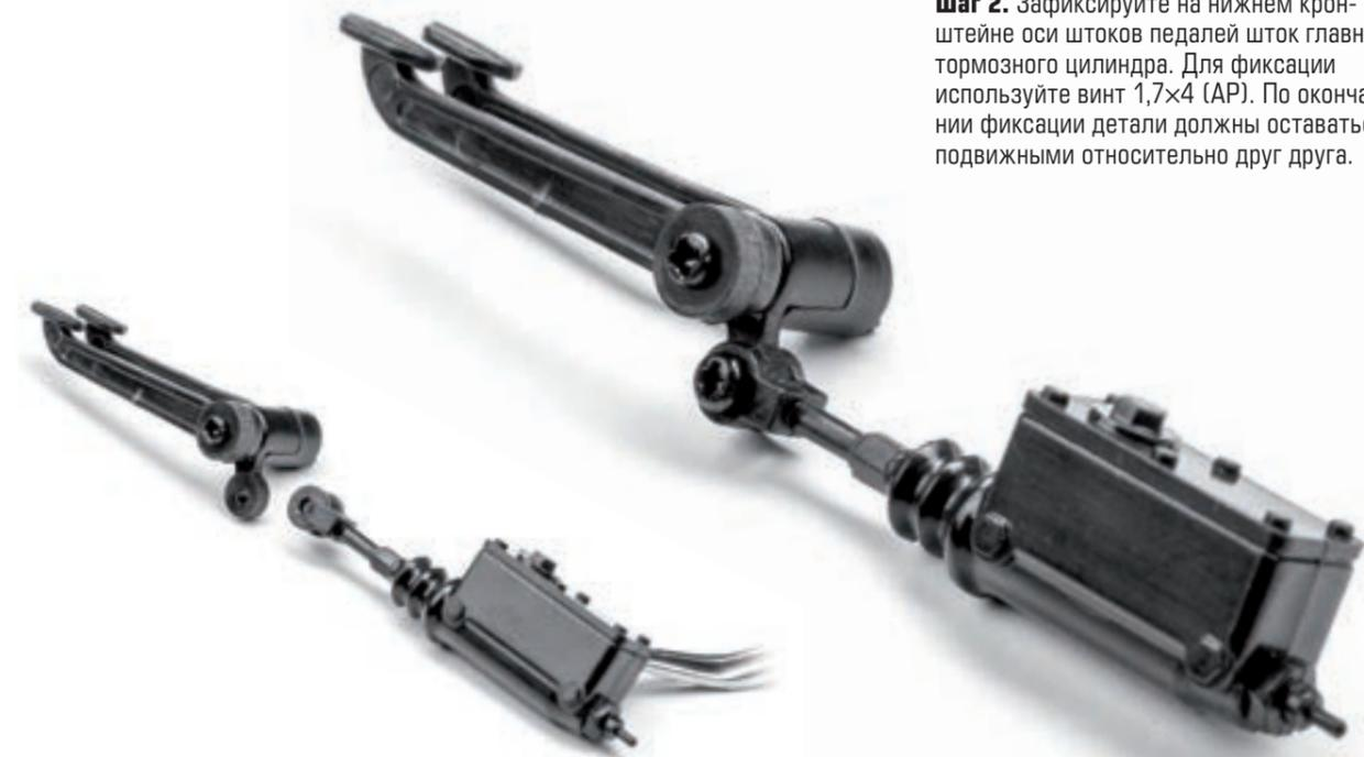
**Шаг 2.** Зафиксируйте на нижнем кронштейне оси штоков педалей шток главного тормозного цилиндра. Для фиксации используйте винт 1,7×4 (АР). По окончании фиксации детали должны оставаться подвижными относительно друг друга.
