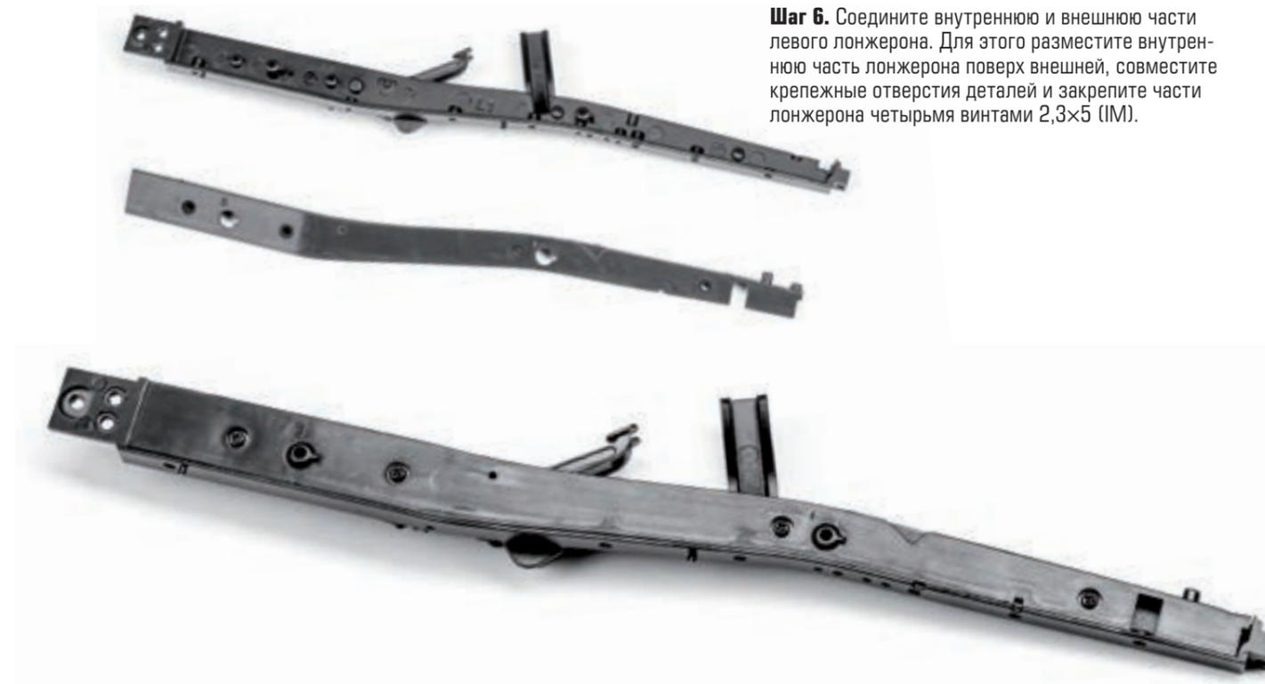
**Шаг 6.** Соедините внутреннюю и внешнюю части левого лонжерона. Для этого разместите внутреннюю часть лонжерона поверх внешней, совместите крепежные отверстия деталей и закрепите части лонжерона четырьмя винтами 2,3×5 (IM).
